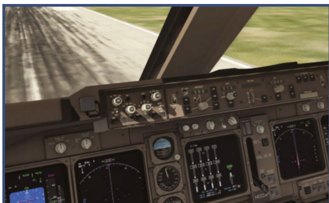
Fig. 4 : Préréglages sur la casquette : vitesse à 200 kts, cap au 213°, altitude cible à 3 000 ft.
