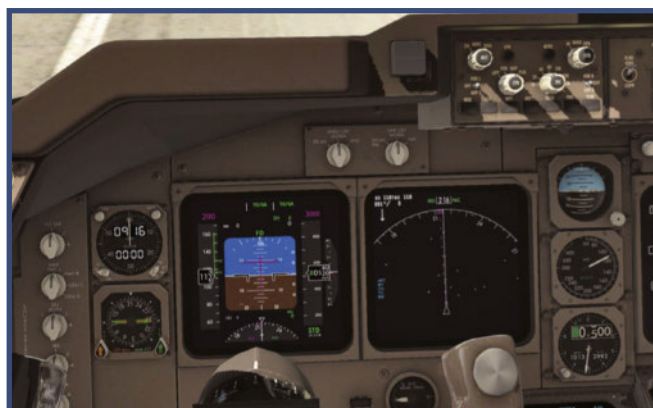
Fig. 5 : Les vitesses V1 et Vr sont affichées sur le PFD en vert : l'avion peu chargé a des vitesses de référence très faibles.
