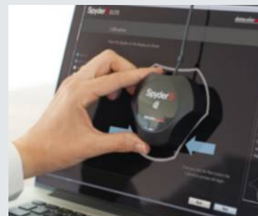
Calibrage à l'aide d'une sonde Spyder 5Elite.
