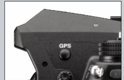
*La nouveauté la plus visible en surface, c'est ce bouton permettant l'activation du GPS, marquant chaque photo de ses coordonnées géographiques. Dommage que le petit flash intégré ait été supprimé au passage !*
