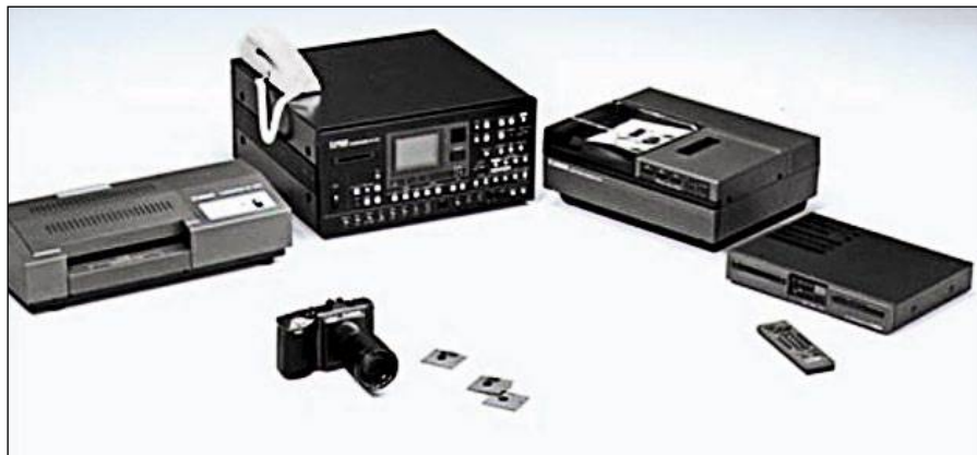
Photo de famille du RC-701 et de ses périphériques. On reconnaît une plastifieuse, un magnifique — et coûteux — modem avec son téléphone, une imprimante et un lecteur de disquettes 2". Il y a même une télécommande mais je ne vois pas trop ce qu'elle pilote...
