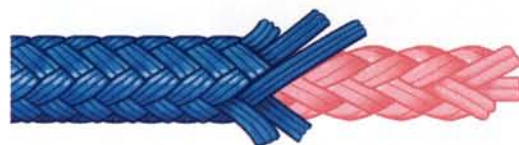
Figure 5 Cordage tressé dont l'âme est constituée de brins tressés; exemple photographique ci-dessus (à droite).
