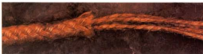
Figure 4 Cordage tressé dont l'âme est constituée de brins toronnés.
