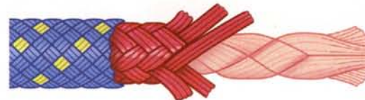
Figure 6 Cordage tressé à trois épaisseurs; exemple photographique ci-dessus (à gauche).
