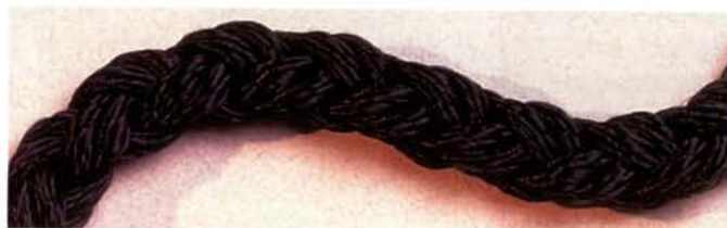
Figure 2 Un cordage tissé à huit torons formé à partir de quatre paires de gros torons peut servir d'amarre pour les gros navires. La photographie ci-dessous montre toutefois une version beaucoup plus petite de ce cordage, plutôt réservé à un usage domestique.
